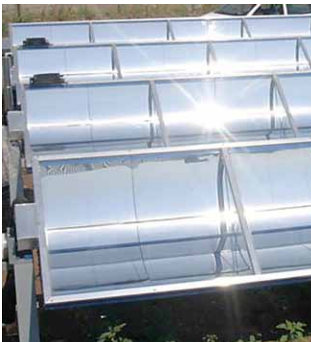
Figure B.5 - Concentrateurs cylindro-paraboliques
