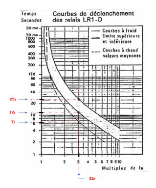
Nota 1: En fonctionnement normal, un moteur est rarement chargé à sa puissance maximale et le relais, thermique toujours réglé pour son courant nominal est donc, dans un état chaud, « intermédiaire ».
