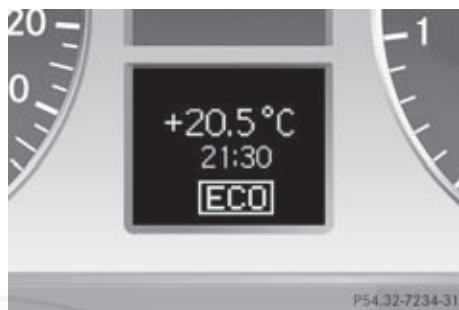
Affichage de la fonction ECO de démarrage et d'arrêt automatiques du moteur (exemple)
