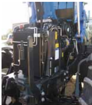
À l'avant, le grand capot monobloc dégage bien l'accès aux radiateurs.
