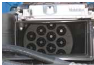
Le préfiltre à air éjecte, par force centrifuge, les particules de poussière dans l'échappement.
