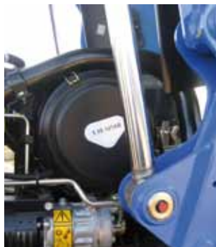
Le bâti du chargeur frontal gêne la dépose du filtre à air.
