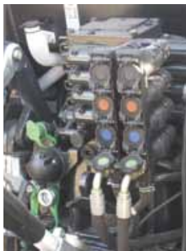
L'un des quatre distributeurs auxiliaires alimente le relevage avant.
