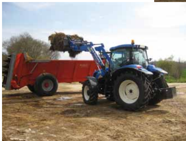
Le T6040, malgré une masse de 800 kg à l'arrière, se révèle moins stable au chargeur que son homologue à six cylindres.
