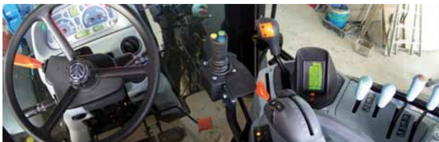
Un code couleur associe chaque levier à un organe du tracteur pour faciliter la prise en main.
