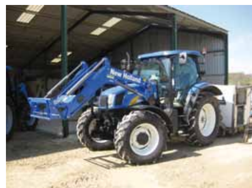
Le six cylindres s'est révélé moins coupleux et plus gourmand en carburant que le quatre cylindres.
