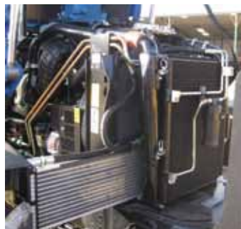
Le refroidisseur d'huile coulisse latéralement, tandis que le condenseur de climatisation s'escamote vers l'avant.
