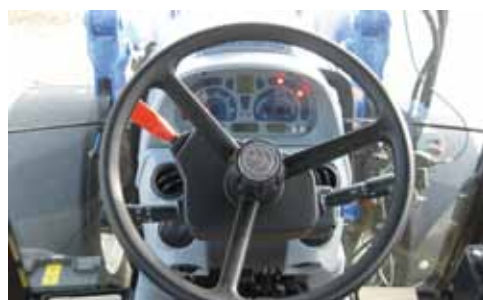
À gauche sous le volant, le levier de l'inverseur électrohydraulique assure le changement du sens de marche sous charge.
