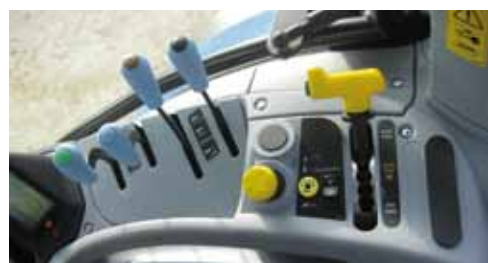
La console latérale accueille la majorité des commandes, à l'instar des distributeurs hydrauliques ou de la prise de force.
