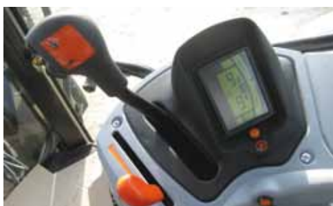
Comme la console latérale, le levier de vitesses intègre trois boutons : deux pour le passage des vitesses powershift et un pour débrayer.
