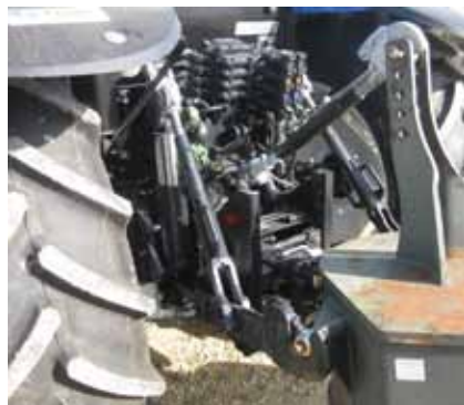
Le relevage arrière, doté de deux vérins de 90 mm de section, lève jusqu'à 7,8 tonnes aux rotules, selon le constructeur.
